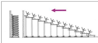
Instalación Anclado a Muro
