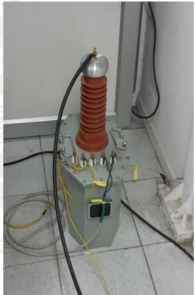
Transformador de HIPOT
